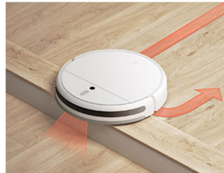
15 высокоточных инфракрасных датчиков спереди, по бокам и снизу обеспечивают отличную навигацию, предотвращая пылесос от столкновения, схождения с траектории и падения с высоты
